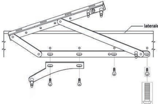
3) Fissare inizialmente le staffe alzarete ai laterali tramite una vite 8x25, testa bombata. Fissare le piastre di collegamento dei pistoni sulle staffe alzarete e sui laterali tramite viti 8x25, testa bombata.
