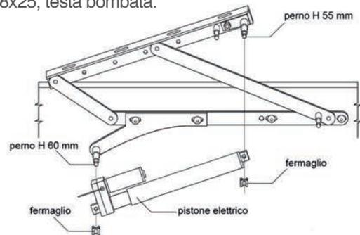
4) Inserire i perni delle piastre di collegamento e delle staffe alzarete nelle basi e nelle testate dei pistoni. Bloccare i perni delle piastre di collegamento e delle staffe alzarete sulle basi e sulle testate dei pistoni tramite i fermagli.
