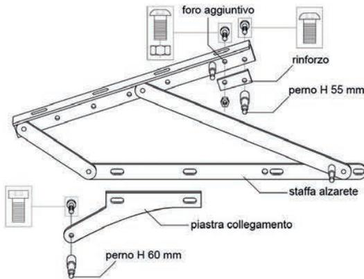
2) Fissare i perni sulle piastre di collegamento dei pistoni, tramite i bulloni 8x16, testa piana ribassata utilizzando le piastrine di rinforzo come maschere. Se mancanti, realizzare i fori aggiuntivi (diametro 8,5 mm) sulle staffe alzarete. Fissare le piastrine di rinforzo sulle staffe alzarete tramite i bulloni 8x16, testa bombata, con dado M8. Fissare i perni sulle piastrine di rinforzo e sulle staffe alzarete tramite i bulloni 8x16, testa bombata.
